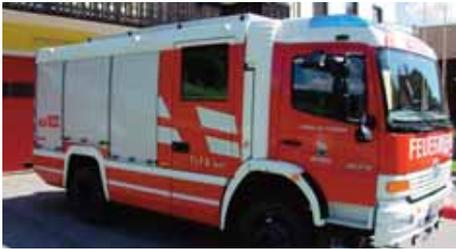
**TLFA** (Tanklöschfahrzeug Allrad): Dieses Fahrzeug ist mit einem 3000 Liter Tank, einer fix eingebauten Mehrbereichspumpe und Atemschutzgeräten ausgestattet. Es ist das wichtigste Fahrzeug bei einem Brandeinsatz. Zusätzlich ist es noch mit einer hydraulischen Seilwinde (5 Tonnen Zugkraft), einem Notstromaggregat, Lichtmast, Hebekissen und vielen Werkzeugen ausgerüstet, um ein großes Einsatzspektrum abdecken zu können.
