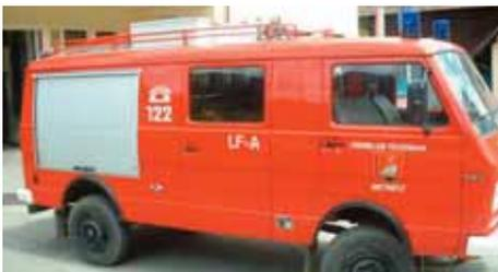
**LFA** (Löschfahrzeug Allrad): Durch das mitgeführte hydraulische Rettungsgerät ist das LFA das erste Fahrzeug, das bei einem Verkehrsunfall ausrückt. Zusätzlich kann dieses Fahrzeug durch eine mitgeführte Tragkraftspritze auch bei Brandeinsätzen eingesetzt werden.
